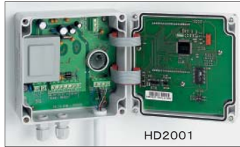
Fig.4 RS232/RS485、アナログ出力選択ディップスイッチ
